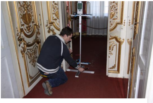
Bild 2: Messung des interzonalen Luftwechsels im Paradeschlafzimmer in Schloss Linderhof
